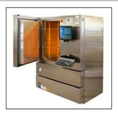
PCO2-14<sup>™</sup> 폴리이미드 경화 솔루션은 폴리이미드 베이킹, 경화 및 멸균 용도로 설계된 세척 공정 오븐입니다. 다양한 반도체 제조 환경에서 첨단 기계류가 폴리이미드 경화에 사용되고 있습니다. 이 공정은 비용이 많이 들어 청결, 불활성 분위기 능력, 사이클 시간 또는 데이터 수집 측면에서 장비가 대개 폴리이미드 경화에 부적합합니다.
