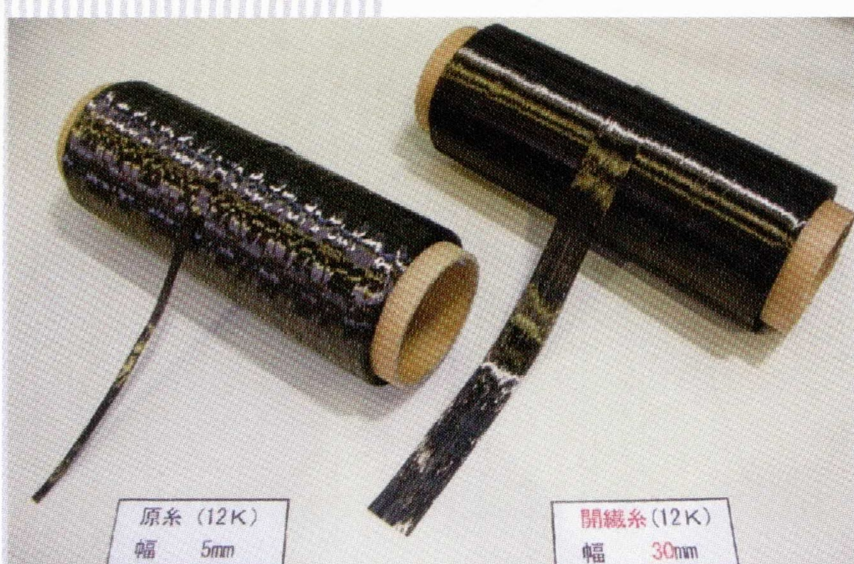
左:12K原糸(幅5mm) 右:12K開織糸(幅30mm) Left: 12K Original-tow (w:5mm) Right: 12K Spread-tow (w:30mm)
